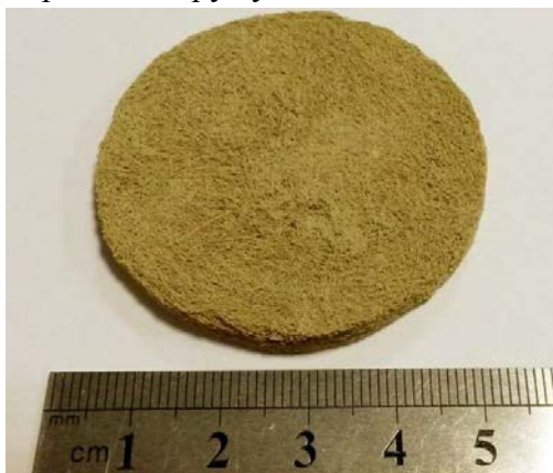
Рисунок 13 – Оптическая фотография рутильного войлока.
